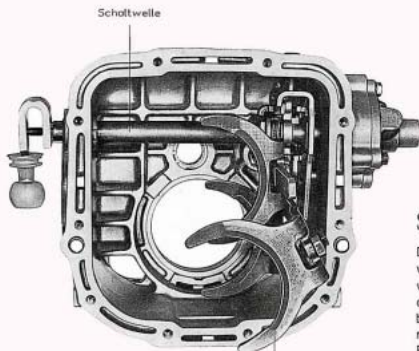
Schaltgabel für Rückwärts- oder 1. u. R.-Gang beim 5-Gang-Schaltgetriebe
